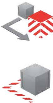
**SCHUTZZONEN** und **ARBEITSBEREICHSGRENZEN** können für Bereiche definiert werden, in die der Kran nicht verfahren werden darf, beispielsweise Lagerflächen oder Bereiche mit Produktionsmaschinen. Arbeitsbereichsgrenzen sind temporäre „virtuelle Grenzen“, an denen der Kran automatisch stoppt. Diese beiden Funktionen dienen der Kollisionsvermeidung zwischen dem Kran und wertvoller Ausrüstung in der näheren Umgebung. Sie verbessern die Sicherheit und verhindern mögliche Schäden.
