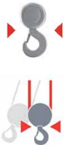
Die **SWAY-CONTROL-LASTPENDELDÄMPFUNG** steuert die Beschleunigungs- und Verzögerungsrampen der Brücken- und der Laufkatzenfahrantriebe und unterdrückt auf diese Weise automatisch das Schwingen der Last. Sie ermöglicht einen schnelleren Lastenumschlag und eine präzisere Positionierung. Diese Funktion verringert außerdem die Gefahr einer Beschädigung des Krans, der Last und des Kranarbeitsbereichs.
