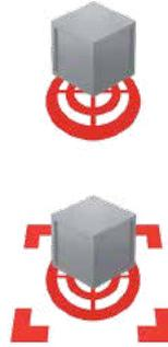
Die **ZIEL- und ENDPOSITIONIERUNGS-FUNKTIONEN** unterstützen die manuelle Kransteuerung. Die Zielpositionierung transportiert die Last auf Knopfdruck zu einer vordefinierten Zielposition. Die Endpositionierungsfunktion befördert die Last bis zur Mitte des endgültigen Positionierungsfensters. Beide Funktionen verkürzen die Zykluszeiten bei häufig wiederholten Kranbewegungen ganz erheblich und tragen zu einer Beschleunigung und Vereinfachung Ihrer Prozesse bei.
