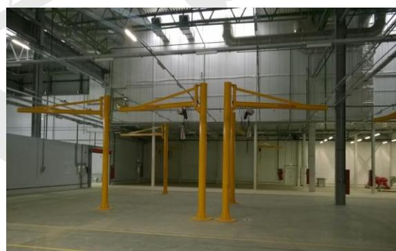
Основной задачей для Konecranes было проектировка и изготовление оборудования и металлоконструкций таким образом, чтобы максимально оставить рабочее пространство для персонала и техники в условиях размера цеха. Также инженерам Konecranes было необходимо демонтировать оборудование компании Demag на существующем производстве и произвести монтаж данного оборудования на месте нового производства.
