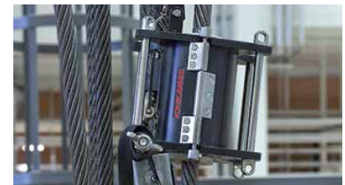
Система RopeQ позволяет проверять состояние внутренних проволок каната, что не представляется возможным с использованием традиционных методов проверки.
