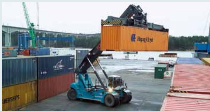
Ричстакеры Konecranes с верхним и нижним захватом поднимают грузы от 10 до 80 тонн. Могут поставляться со специальным навесным оборудованием для целей автомобильного производства.
