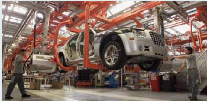
Манипулятор Konecranes с гайковертом для сборки колес на заводе Magna в Австрии
