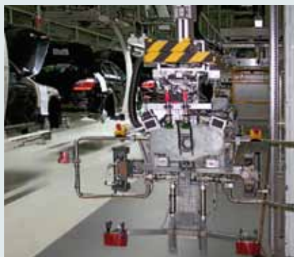
Манипулятор Konecranes, в основе конструкции которого - вертикальный подъемник для передних модулей, на заводе BMW в Германии.
