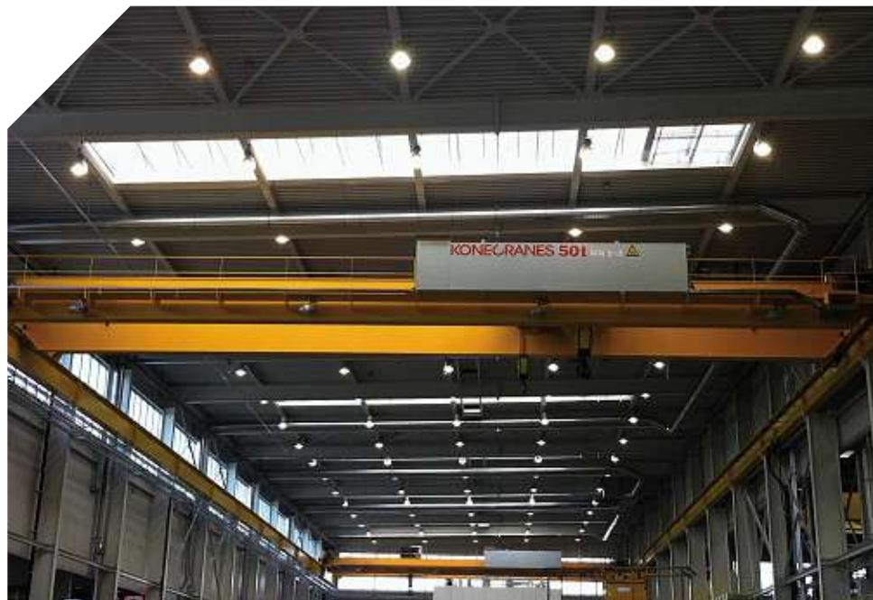
использования кранов. Отчеты TRUCONNECT дают подробную информацию о кране в целом, включая тележку и мост, о рабочих циклах крана, спектре его нагружения и остаточном ресурсе.
