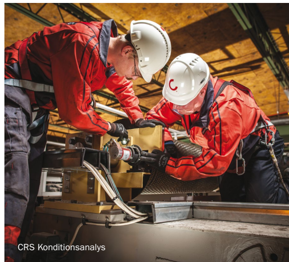
RopeQ Magnetisk lininspektion
