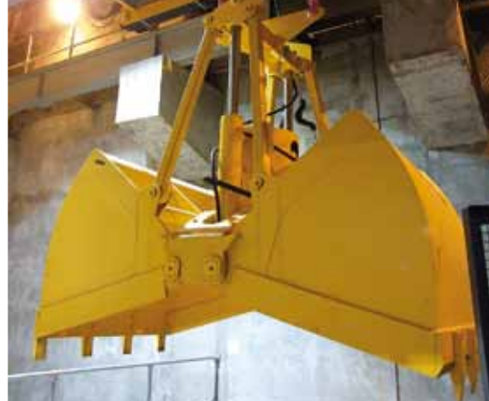
Лейксайд, Великобритания: кран для транспортировки шлама грузоподъемностью 10 тонн
