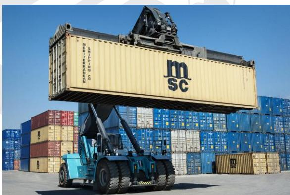
«Новорослесэкспорт» впервые в России купила рейлстакер с грузоподъемностью 45 тонн при вылете стрелы 6 400мм, для обработки полностью груженых контейнеров со 2ого железнодорожного пути. Подобные рейлстакеры часто оснащаются комбиспредером, способным поднимать как контейнеры, так и трейлеры.
