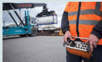
Пульт радиоуправления для погрузочно-разгрузочных работ на железнодорожном и морском транспорте
