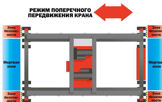
Рисунки 6 и 7. Зоны безопасности предварительно программируются в соответствии с нормативными требованиями и собственными требованиями вашего терминала. На иллюстрациях: режимы нормального и поперечного передвижения крана. Также имеется режим "Поворот". В режиме поперечного передвижения можно исключить "мертвые зоны", установив дополнительные лазерные датчики.
