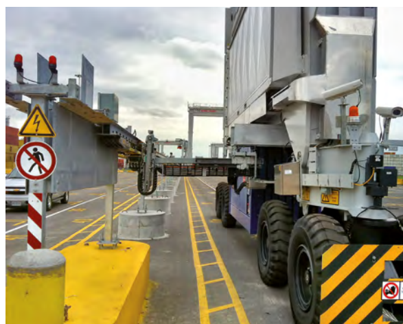
Рисунок 5. В порту Georgia Ports Authority (GPA), Саванна, штат Джорджия, США, работают более 120 кранов RTG производства Konecranes, включая краны, оснащенные шинопроводом, которые изображены на данной фотографии. Порт GPA планирует к 2022 году увеличить количество полностью электрических кранов до 150 единиц путем приобретения новых электрических кранов RTG и переоборудования существующих.
