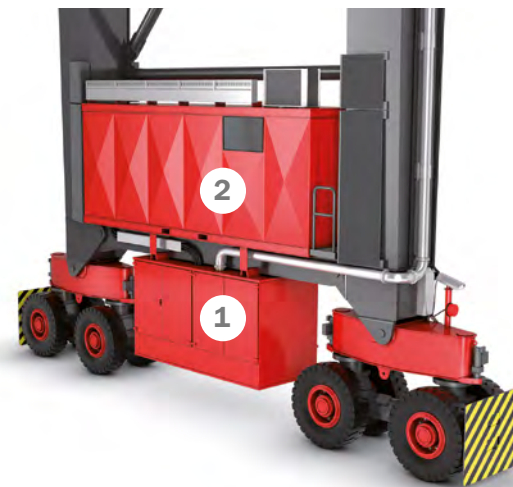
Рисунок 2. Система встраивается в корпус дизель-генератора (1), и соответствующие изменения вносятся в электрическую систему в электропомещении (2). Также выполняются некоторые модификации программного обеспечения.
