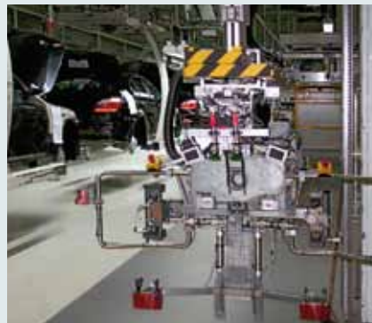
Ein Manipulator von Konecranes auf der Basis einer vertikalen Hubsäule für Vordermodule bei BMW in Deutschland.
