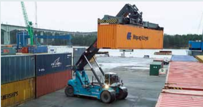
Reach Stackers von Konecranes heben zwischen 10 und 80 Tonnen von oben oder von unten. Sie können mit speziellen Aufsätzen für Prozesse in der Kraftfahrzeugindustrie ausgestattet werden.
