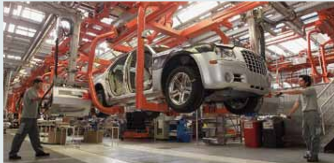
Ein Manipulator von Konecranes mit Kraftschrauber zur Radmontage bei Magna in Österreich.
