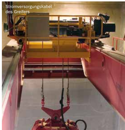
Schlackekran mit einer Kapazität von 10 Tonnen in Lakeside, Großbritannien
