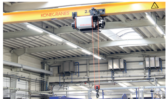
S-Serie Kran mit Synthetikseil zur Bestückung der Abwickelmaschine mit Aluminiumcoils
