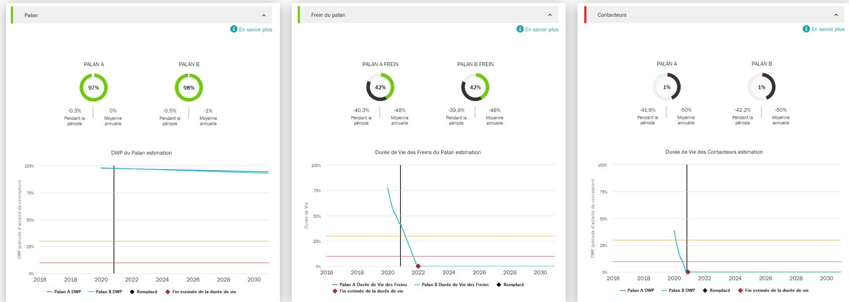
Le DWP du palan est le calcul de la durée de vie restante du palan et une indication de la durée de vie restante en fatigue des composants de l'équipement. Lorsque la valeur du DWP approche de zéro, le palan doit être révisé ou remplacé.
