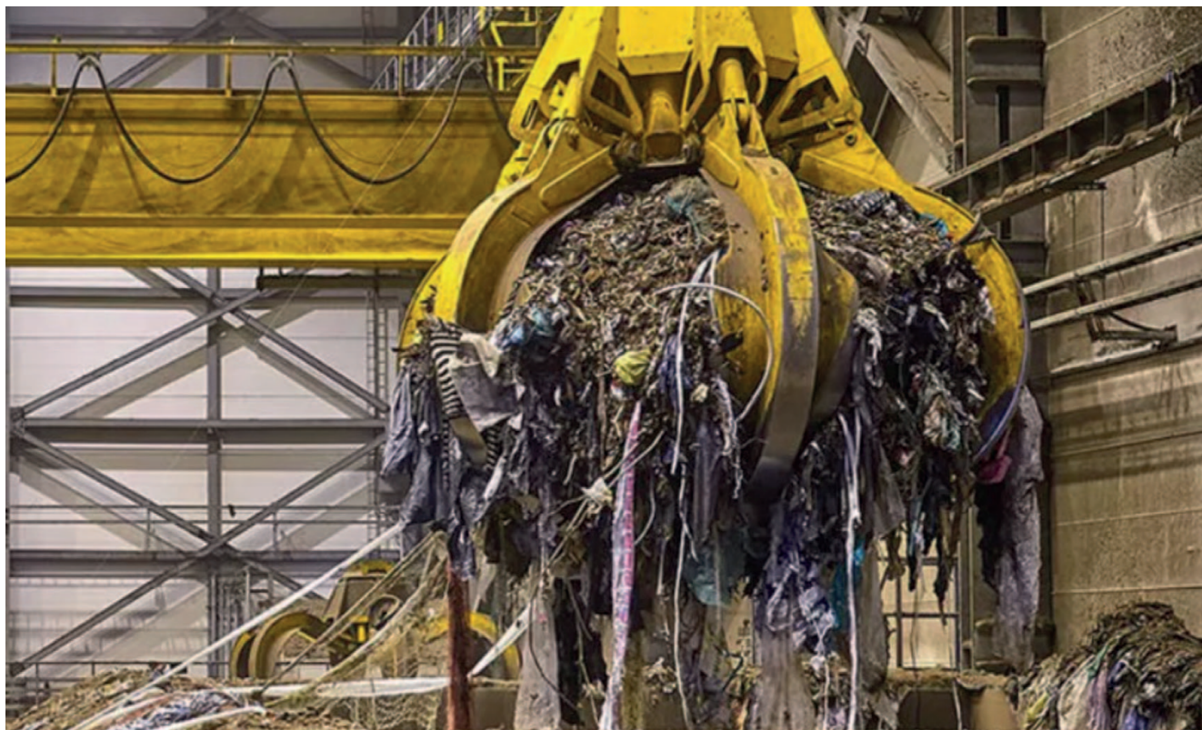
Jeřáb skládá a míchá odpad v bunkru spalovny a překládá ho do zásobníku.
