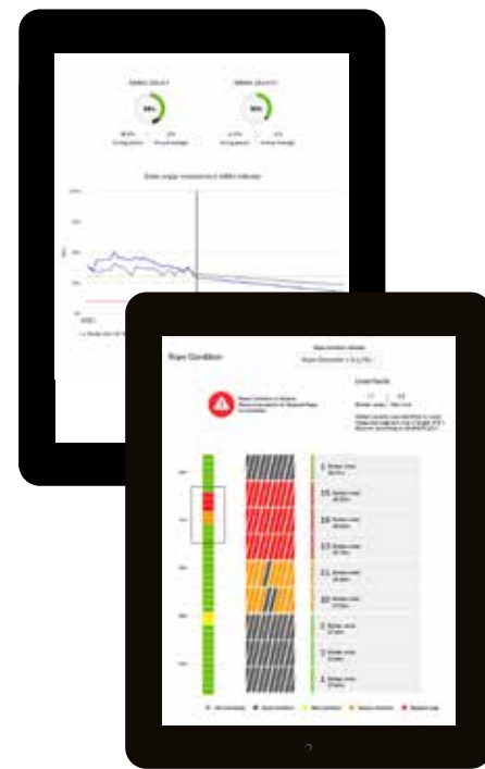
Oben: TRUCONNECT Bremsüberwachungsdaten am Konecranes Portal. Unten: TRUCONNECT Seilüberwachungsdaten am Konecranes Portal.
