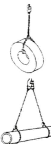
Bei einem Schnürgang muss dafür gesorgt werden, dass sich ein Winkel von ca. 60° einstellen kann (siehe Abbildung), der nicht durch zusätzliches Nachspannen verändert werden darf, da sonst unzulässige Belastungen im Strang auftreten können.
