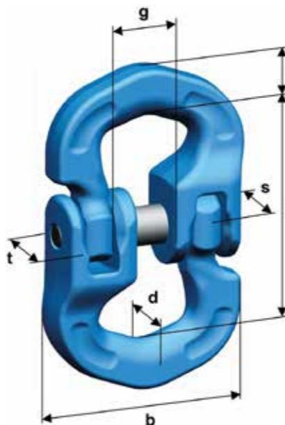
Das Verbindungsglied ist so gebaut, dass der PWP Verkürzungshaken zusammen mit der Kette in eine Hälfte adjustiert werden kann. Damit kann ein Gehänge kostengünstig mit Verkürzer gebaut werden. Die Glieder können bis zu drei Mal durch eine sachkundige Person montiert und demontiert werden, erst danach sind Bolzen und Hülse, die auch als Ersatzteilgarnitur erhältlich sind, zu tauschen.
