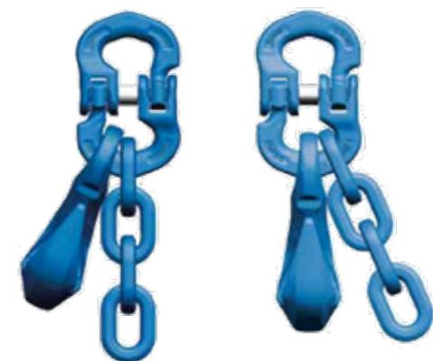
Das Verbindungsglied ist weit genug, um Verkürzer und Kette aufzunehmen. Das belastete Teil (Kette oder Haken) kann sich mittig positionieren und die symmetrische Belastung des Verbindungsgliedes ist gegeben.
