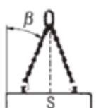
Für zweisträngige Anschlagmittel sollten beide Anschlagpunkte oberhalb des Lastschwerpunktes liegen.
