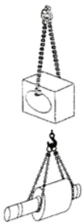
In diesem Fall wird das Anschlagmittel im Idealfall durch eine Öffnung der Last hindurchgeführt und beide Ösen bzw. Schlaufen im Kranhaken direkt eingehängt.
