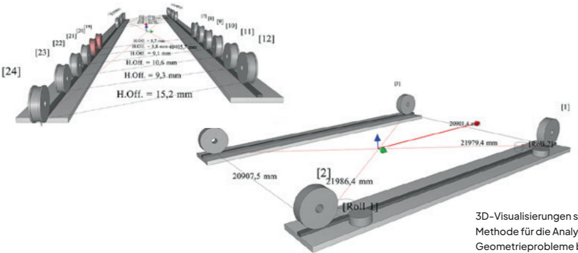
3D-Visualisierungen sind eine einzigartige Methode für die Analyse potenzieller Geometrieprobleme bei Laufrädern, Kopf- und Kranträgern.
