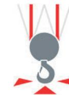
Haken- bzw. Schwerpunktzentrierung positioniert die Brücke und die Laufkatze automatisch direkt über der Last, um Seitenzugkräfte zu eliminieren.
