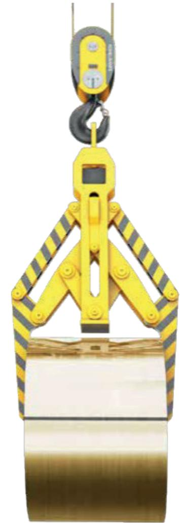
Coil Magnet oder Coil Greifer
