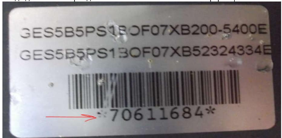
Номер отражен на корпусе редуктора в виде наклейки (для малых размеров) или стальной пластины с лазерной гравировкой. В редких случаях для старого оборудования шильды редуктора и двигателя выполнены методом кернения.
