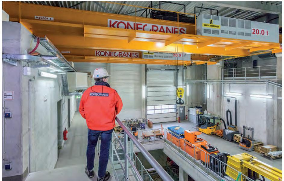
nenten und großer Betonplatten. Die zwei CXT-Zweiträger-Brückenkrane am Tunneleingang sparen zudem durch gedrehte Kabeltrommeln Platz und können synchron im Tandembetrieb arbeiten.
