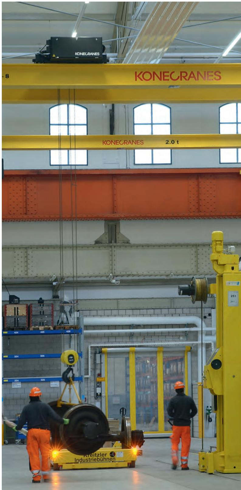
Konecranes hat für die Schweizerischen Bundesbahnen (SBB) zehn Ein- und Zweiträgerbrückenkrane sowie zwei Leichtkransysteme konzipiert.
