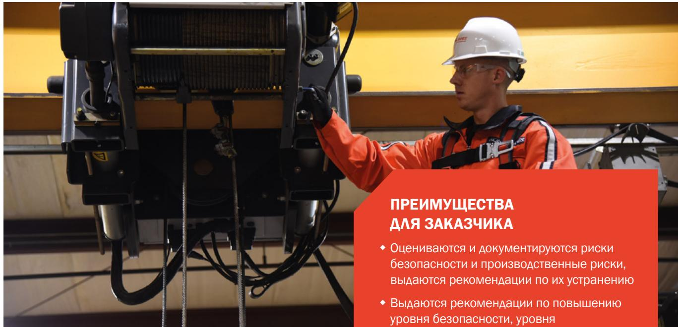
Данная услуга предполагает проверку электрических компонентов оборудования на наличие недостатков и отклонений от рекомендаций изготовителя и применяемых стандартов, которые могут отрицательно повлиять на безопасность эксплуатации оборудования.
