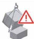
**ЗАЩИТА, СРАБАТЫВАЮЩАЯ ПРИ ЗАЦЕПЛЕНИИ ГРУЗА,** останавливает все движения крана при случайном зацеплении крюка, стропа или груза о препятствие. Данная функция снижает риск аварийных ситуаций при перемещении груза и предотвращает повреждение груза, крана и расположенного вблизи производственного оборудования.
