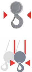
**Функция КОНТРОЛЯ РАСКАЧИВАНИЯ ГРУЗА** предотвращает раскачивание груза, корректируя ускорение и замедление тележки и моста. С данной функцией значительно сокращается длительность рабочего цикла, повышается точность позиционирования груза, снижается риск повреждения груза, крана и расположенного вблизи производственного оборудования.
